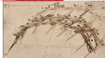
Puente de viga en arco de madera tejida de Leonardo da Vinci en el Códice Atlántico f. 69ar y 71v (1487-1489).
