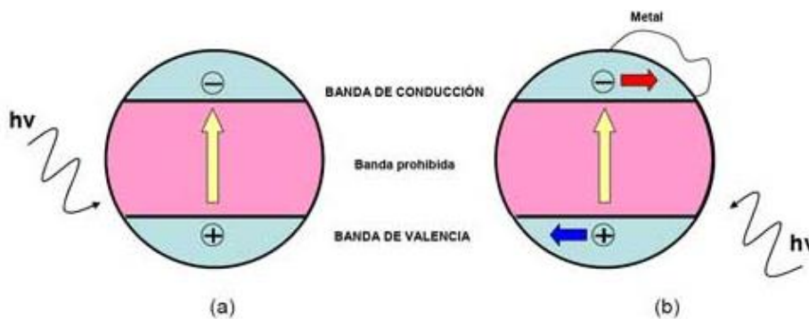
Figura 4. Representación esquemática del proceso fotocatalítico. (a) Banda prohibida de un semiconductor (b) flujo de electrones del semiconductor a un metal [10].
