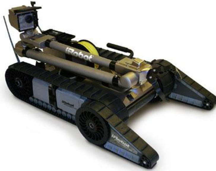
*Figura 13: Robot dotado de oruga*
