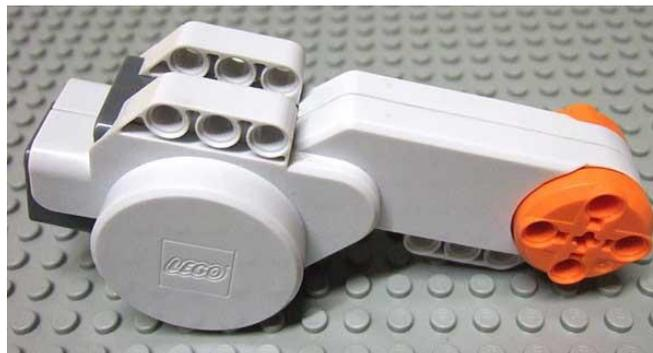
*Figura 34: Motor de Lego*
