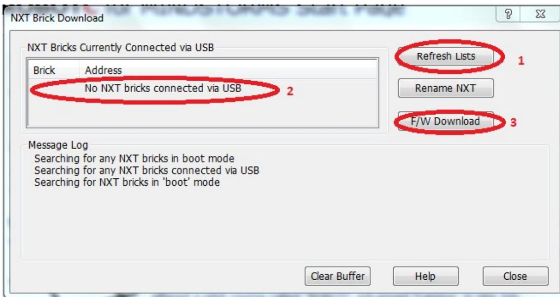
Figura 49: Ventana para instalar firmware en el NXT
