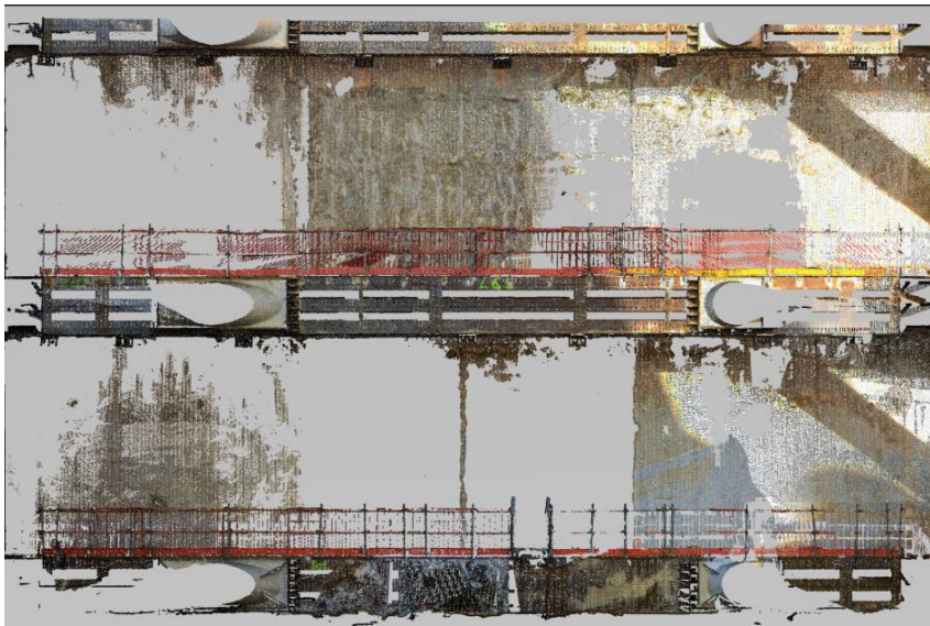
Figure 103. Superposition du nuage de points sur le modèle 3D dans 3D RESHAPER.
