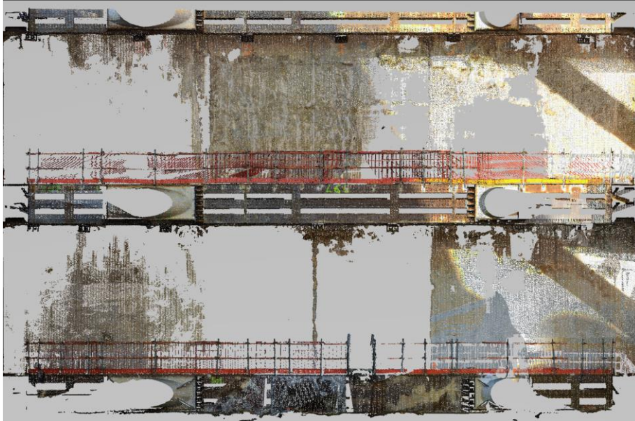
Figure 116. Vue en élévation du nuage de points superposé sur la coupe A-A dans 3DR.
