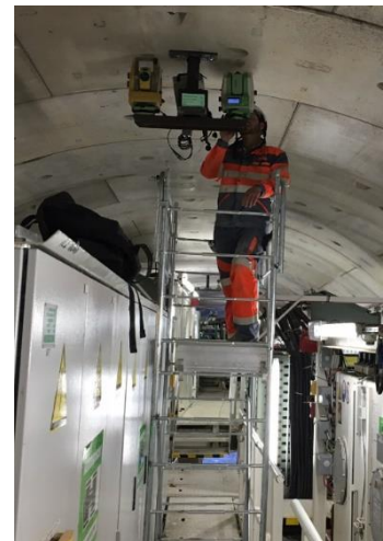
Figure 127. Console double pour la polygonale secondaire.
