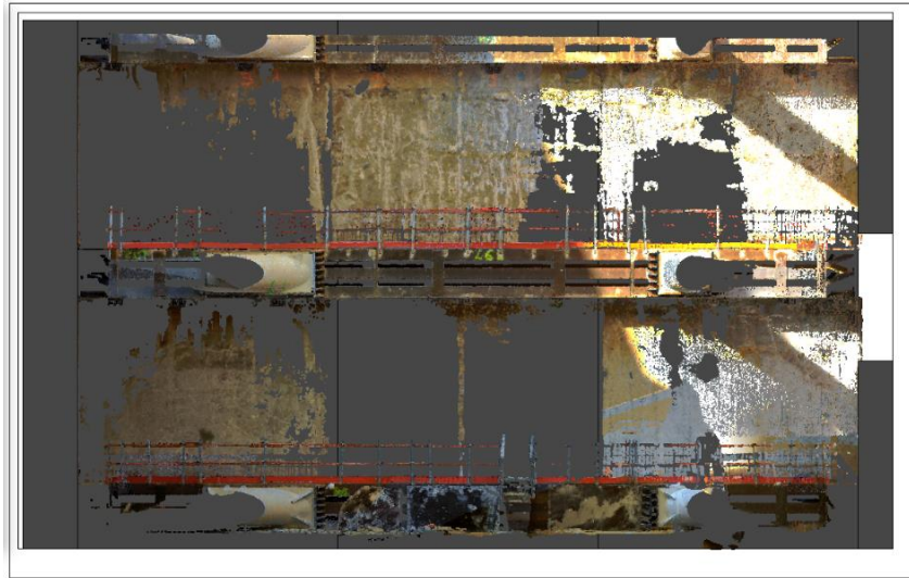
Figure 65. Vue en élévation du nuage de point sur modèle 3D de la paroi moulée.
