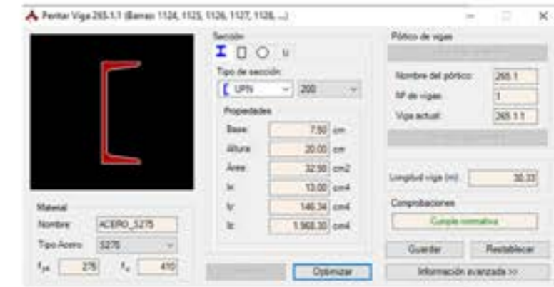
Comprobación de una de las viguetas más desfavorables
