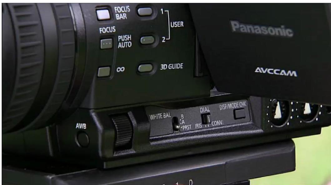
*Fig 2.2 Imagen de la posición de la rueda de convergencia en la cámara 3D de Panasonic.*
