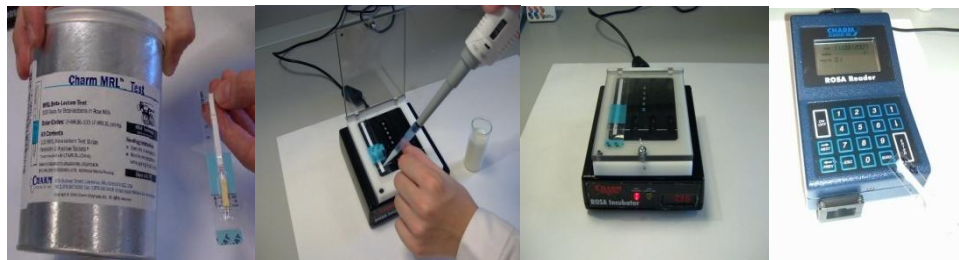
Figura 25. Procedimiento analítico del método de unión a receptores proteicos Rosa Charm
