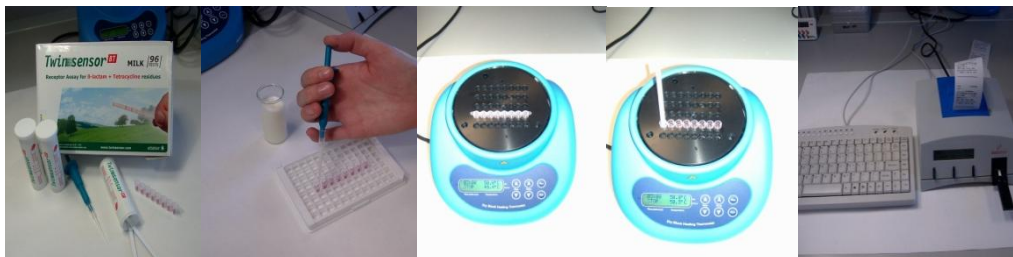
Figura 27. Procedimiento analítico del método de unión a receptores proteicos Twinsensor
