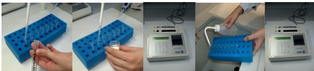
Figura 24. Procedimiento analítico del método de unión a receptores proteicos Delvo-X-Press
