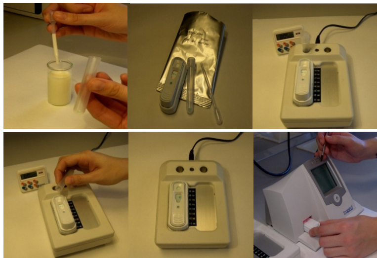
Figura 26. Procedimiento analítico del método de unión a receptores proteicos Snap
