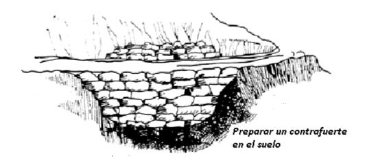
Figura 20. Ejemplo de muro de retención.
