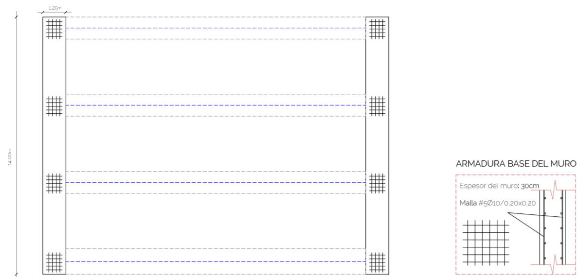
Armado de los elementos verticales que conforman la costilla E 1/200
