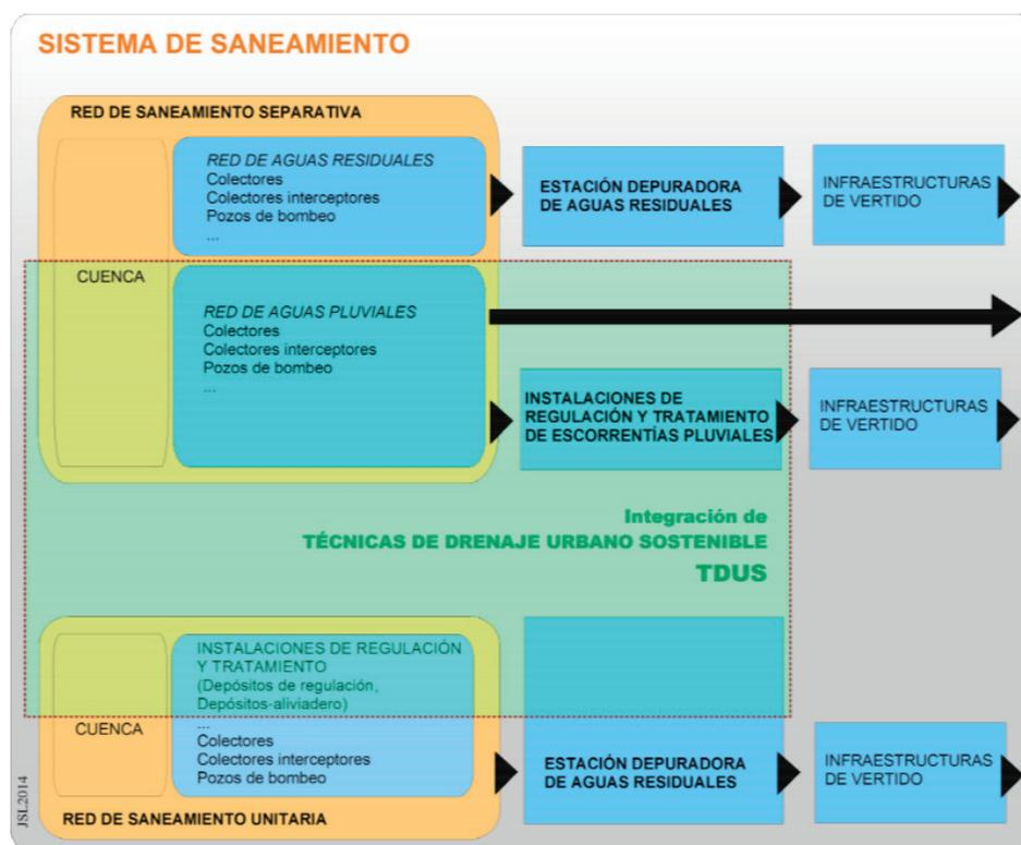
**Figura 6 |** Esquemas conceptuales de sistemas de saneamiento unitario y separativo en los cuales se integran las "Instalaciones de Regulación y Tratamiento" (IRT) y las "Técnicas de Drenaje Urbano Sostenible" (TDUS) (elaboración propia).
