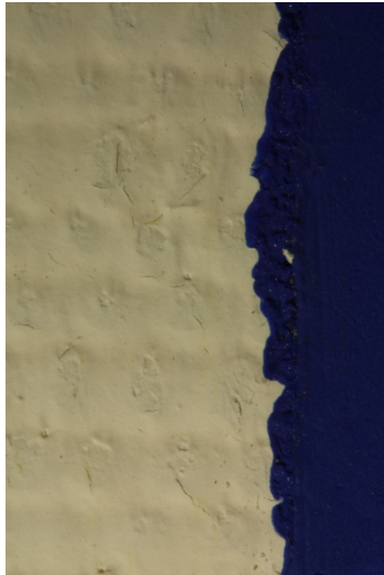
Fig. 7: Fotografía con lupa binocular a 50X. La imagen corresponde al azul cobalto decolorado por envejecimiento UV. Grietas aisladas en la superficie que no afectan a la capa pictórica.
