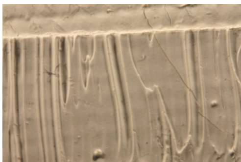
Fig. 12: Fotografía realizada con lupa binocular a 25X. Se observan grietas invadiendo a la capa pictórica desde la imprimación. Ensayo 37 sometido a h y t.
