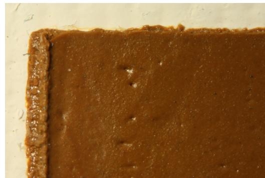
Fig. 10: Fotografía con lupa binocular. Podemos observar que la superficie permanece igual de lisa tras el envejecimiento UV en el ensayo tierra natural con 5% de secativo.
