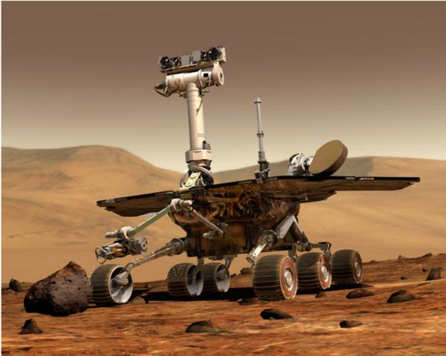
1. Nave navegando por la superficie de Marte. Arriba de la imagen se pueden observar las cámaras.
