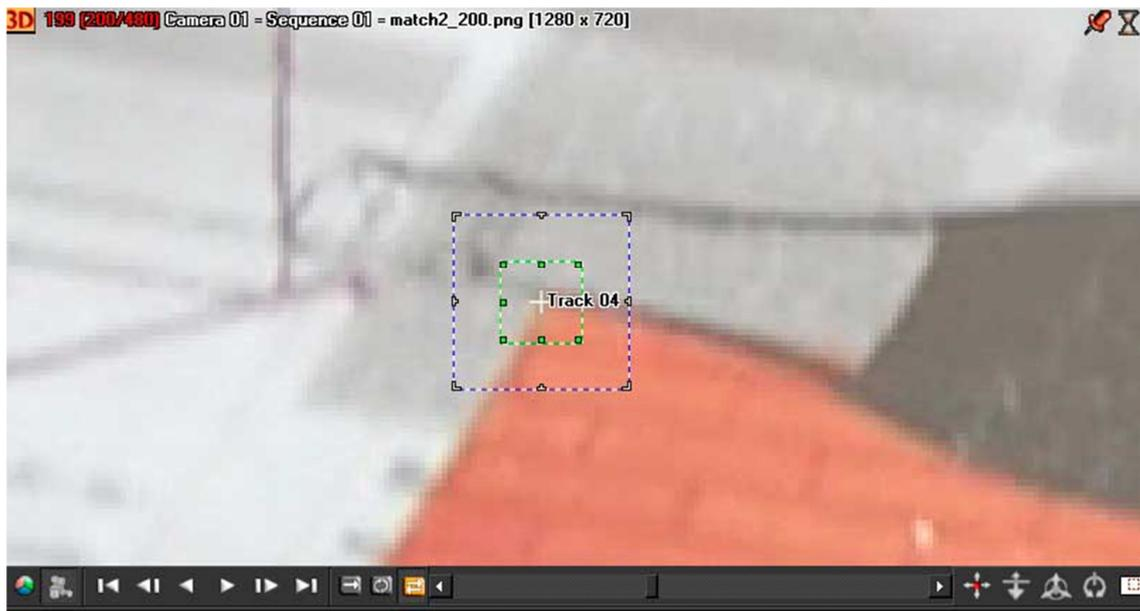
6. Punto de tracking en el que se observan sus 3 partes: el punto central, el área de muestra y el área de búsqueda.
