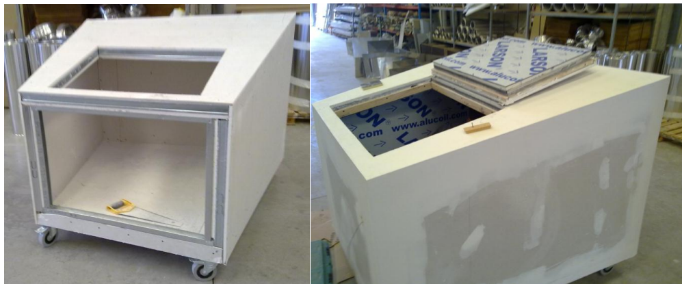
Fig. 27. Detalle cámara reverberante a escala a falta del cierre lateral.
