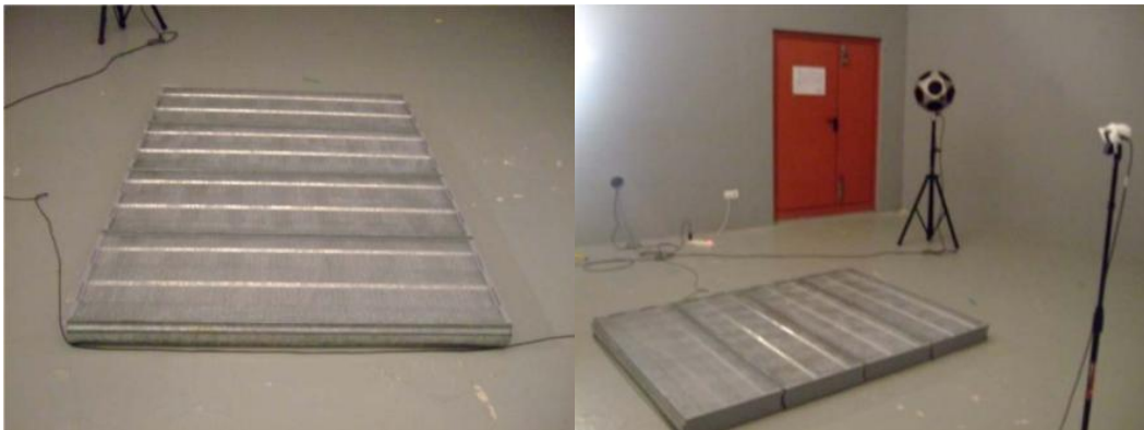
Fig. 30. Pantalla acústica tamaño real.
