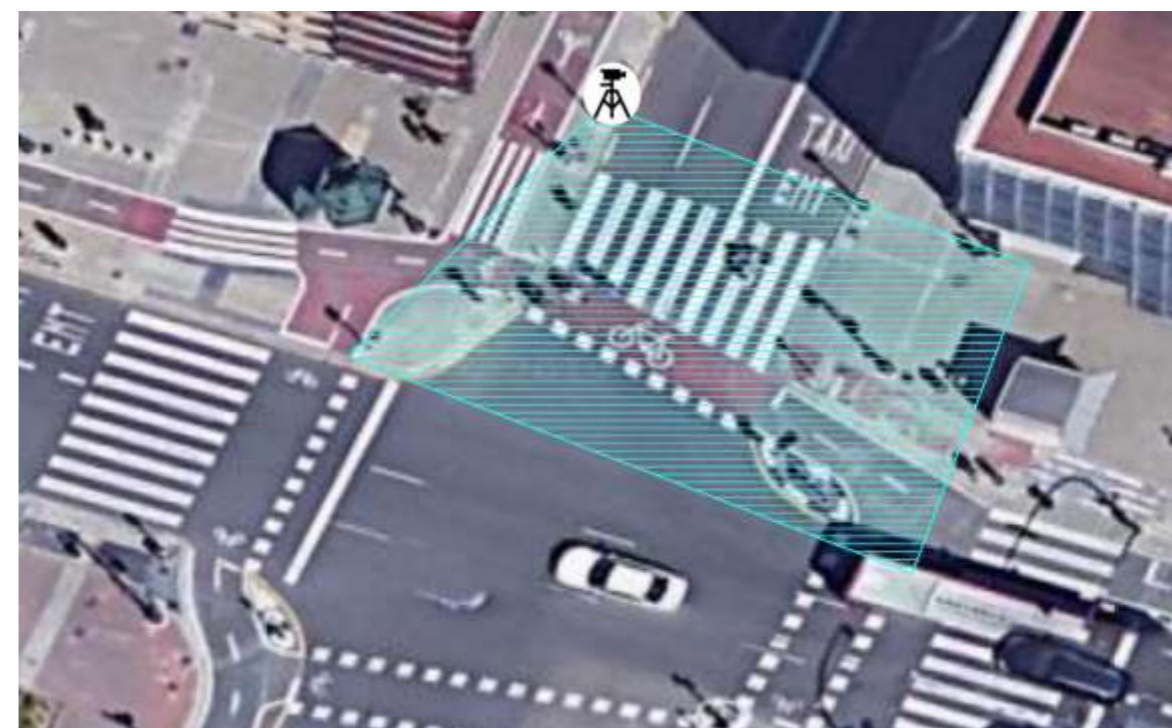
Figura 29. Ubicación de la cámara en la intersección 2 para ver la zona de conflictos. Fuente: Elaboración propia
