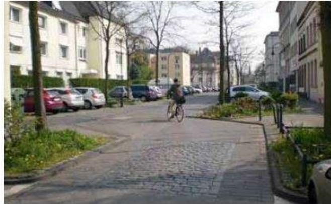
Figura 19_ Ruptura de la linealidad de la calle y cambio de pavimento. Berlín.
