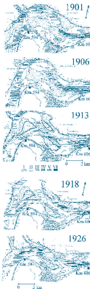
Figura 10. Rectificación subacuática de la onda del thalweg frente a la ciudad de Paraná (desarrollada entre 1906 y 1913), y obliteración, por sedimentación, de la traza preexistente (1926 vs. 1918). I: bancos de arena (áreas del cauce por encima del 0 m de la escala hidrométrica local); II – VI: profundidades crecientes desde el 0 m del hidrómetro, cada 5 m (i.e., VI: profundidades mayores a 20 m por debajo del 0 m de la escala). (Reproducida de Prestien, 1971).
