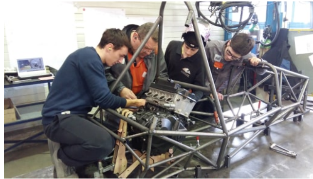
Figure 4.4: Soldadura de las fijaciones del motor sobre el chasis
