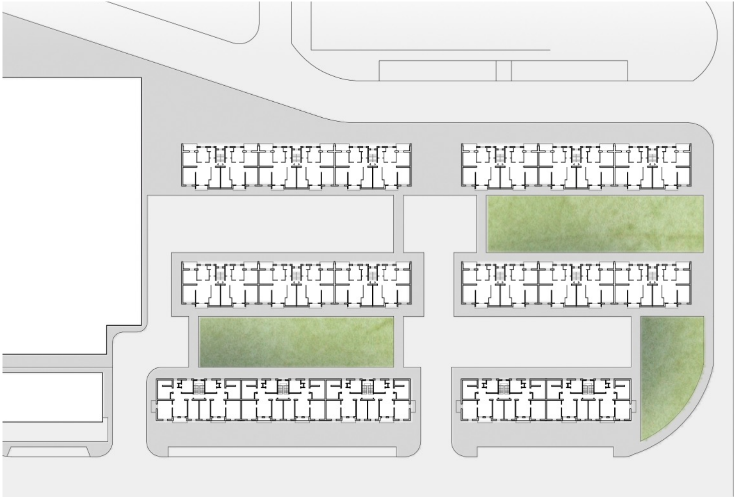
Imagen 28. Tipología de vivienda (A y B) y núcleos de comunicación vertical. Esc 1/750 m Fuente: elaboración propia a partir de los planos que aparecen en el Análisis de la vulnerabilidad sísmica del grupo de viviendas Virgen de La Fuensanta en Valencia, elaborado por Arianna Guardiola Villora y Luisa Basset Salom.
