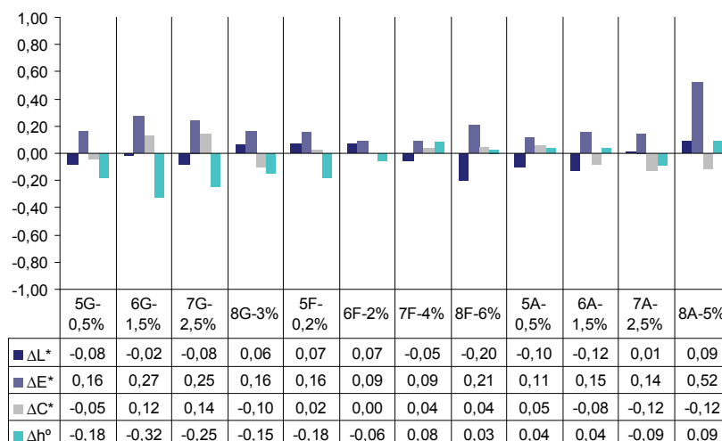
Gráfico 4; \Delta L^* , \Delta E^* , \Delta C^* y \Delta h^\circ de las muestras consolidadas a vaporizador y mini-mesa de succión después del ensayo de envejecimiento artificial acelerado por HR% y temperatura
