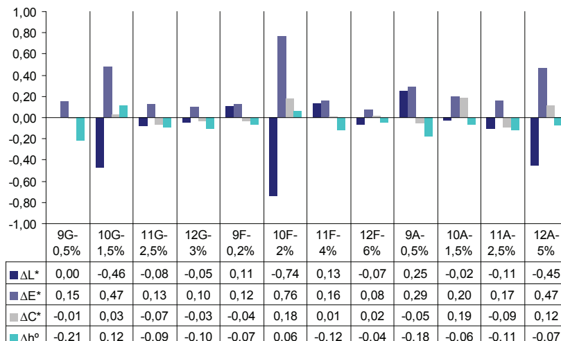
Gráfico 2; \Delta L^* , \Delta E^* , \Delta C^* y \Delta h^\circ de las muestras consolidadas a pincel después del ensayo de envejecimiento artificial acelerado por HR% y temperatura
