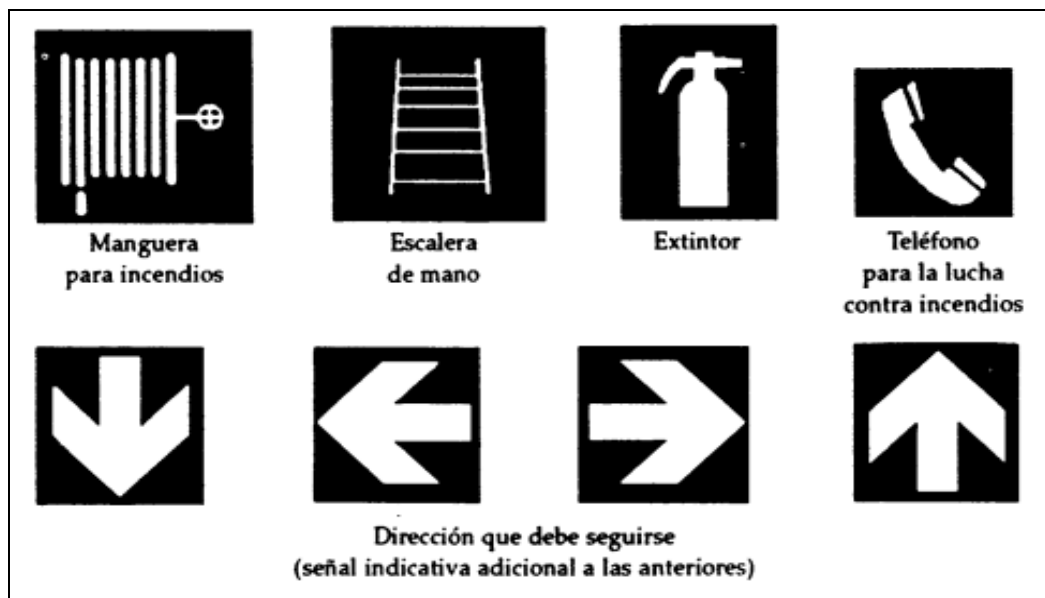
Figura 13. Señales relativas a la lucha contra incendios.
