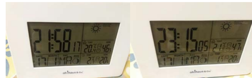
Fig.64 En estas imágenes se compara, a fecha 17 de enero, la diferencia de temperatura exterior e interior sin el funcionamiento de la chimenea. En la fotografía de la derecha se aprecia una temperatura exterior de 1,5°, mientras que en el interior se goza de unos 21,6°C.
