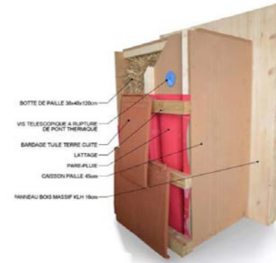
Fig. 55 Detalle constructivo de fachada
