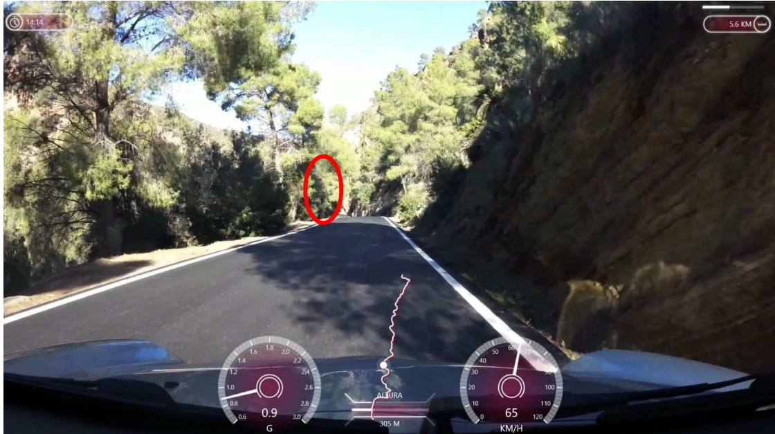
Ilustración 97. CV-25 en P.K. 12+400, sentido creciente de PP.KK. Recorte vegetal de la masa indicada en la imagen para mejora de la visibilidad
