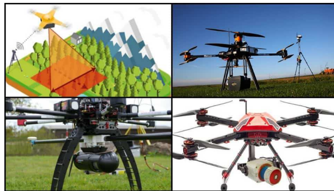
Ilustración 19. Tecnología LIDAR sobre drones. (xdrones.es, 2017)
