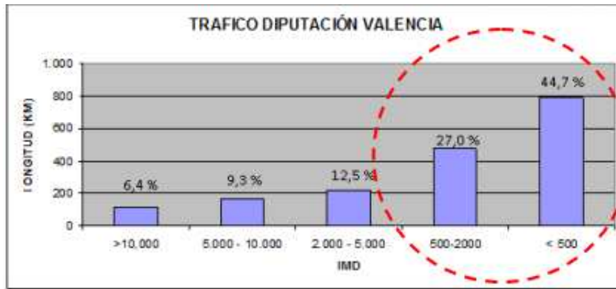
Ilustración 5. Distribución de la red de carreteras de la Diputació de València; longitud total según IMD. (Coexistencia entre ciclistas y tráfico motorizado: la bicicleta en la red de carreteras de la Diputación de València. Javier Piedra Cabanes, 2015)
