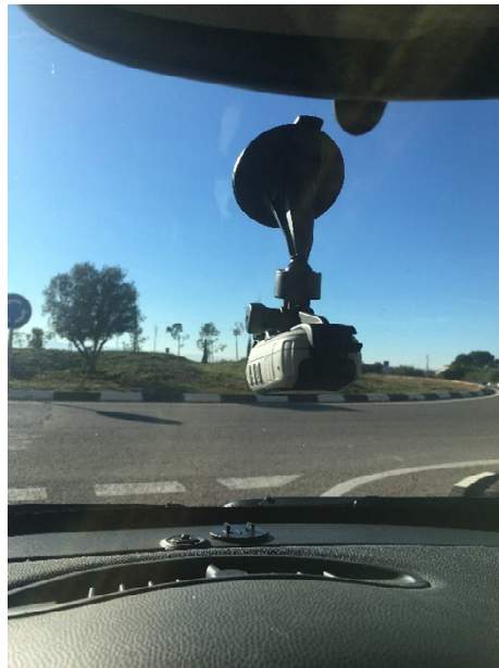
Ilustración 34. Imagen tomada desde el vehículo instrumentado para la toma de datos de V85.
