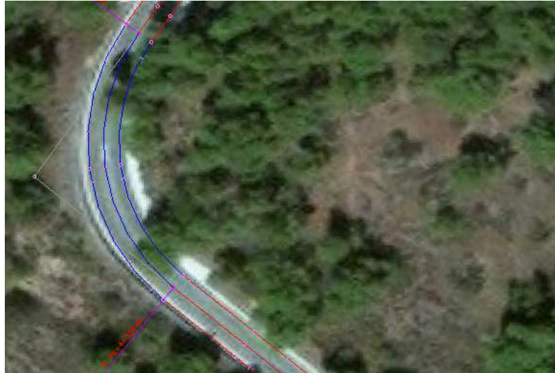
Ilustración 29 Aspecto del espacio de trabajo en AutoCAD Civil3D con ortofotografía de fondo.
