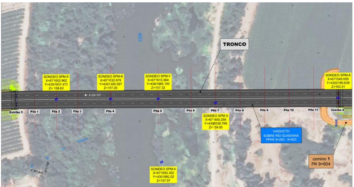
Ilustración 6: Ensayos de campo ejecutados en la segunda campaña (Fuente: Estudio geotécnico)
