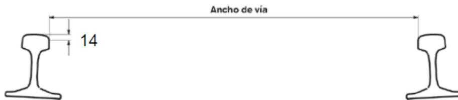
Figura N° 121 – Ancho de vía. Fuente: López Pita, A. 2006. Infraestructuras ferroviarias.
