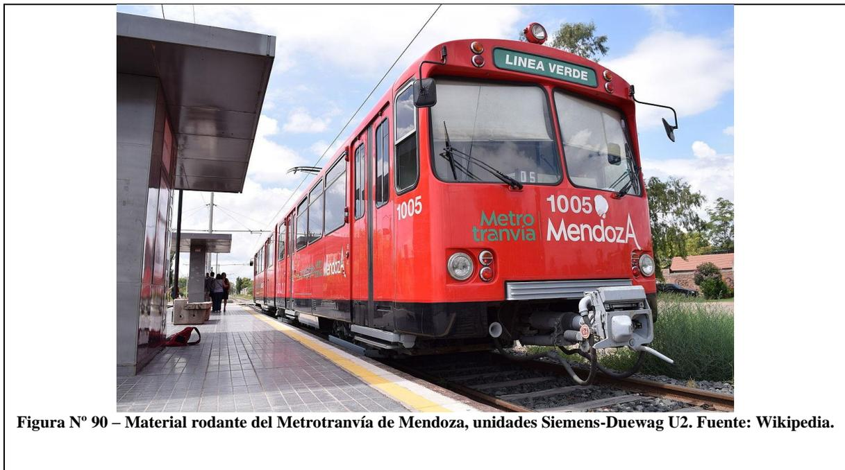
Figura N° 90 – Material rodante del Metrotranvía de Mendoza, unidades Siemens-Duewag U2. Fuente: Wikipedia.
