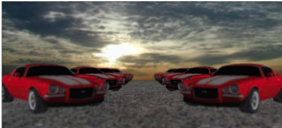
Figura 3.5: Efecto de profundidad de campo generado con un filtro de difusión anisotrópica y la información del Z-Buffer [BFSC04]. En la imagen, el punto de enfoque ha sido puesto en la segunda fila de coches.
