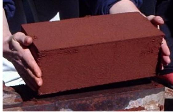
contenido de agua, una mayor compactación y una mayor resistencia a la compresión, además el acabado de la pieza es mejor que el de una adobe prensado de forma tradicional. Además el prensado mediante medios mecánicos permite un almacenaje inmediato y una superficie de fabricación y secado mucho más reducida. Aunque por el contrario el proceso de fabricación resulta mucho más lento y el incremento en el coste derivado de la utilización de la maquinaria mucho mayor.
