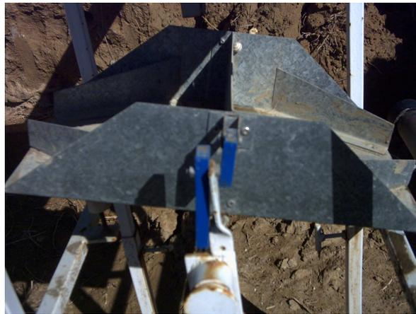
Figura 2. Basculador con sensor de proximidad
