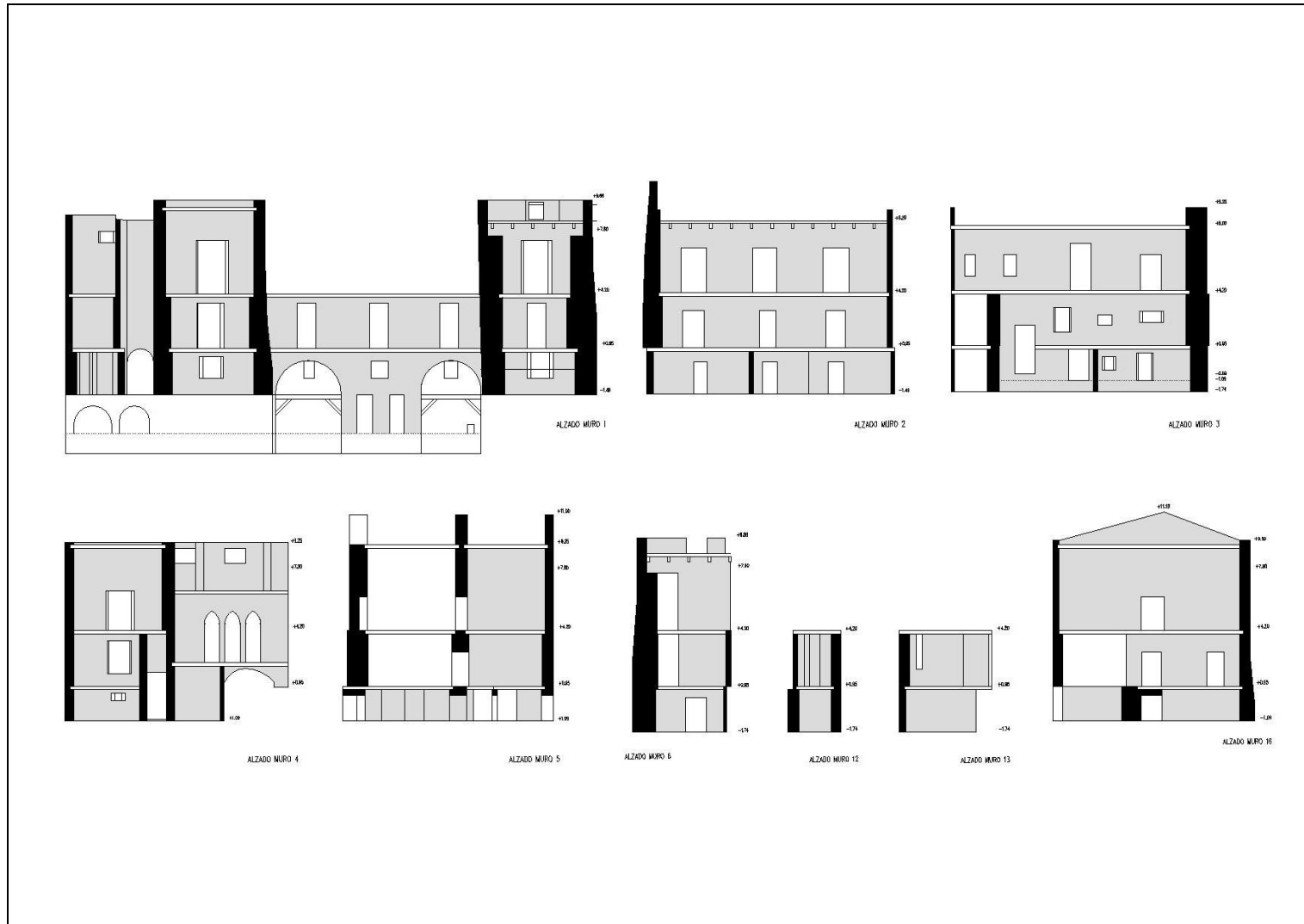
Alzado Muros 1, 2, 3, 4, 5, 6, 12, 13 y 16 Estado actual 1984
