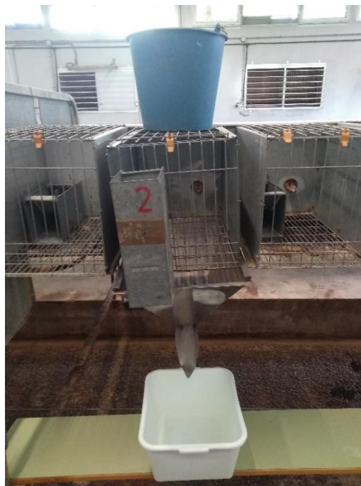
Figura 4. Jaula de digestibilidad. Fuente: Elaboración propia.
