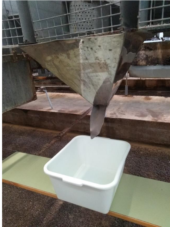
Figura 5. Dispositivo para colecta de heces y cubeta para recoger la orina. Fuente: Elaboración propia.
