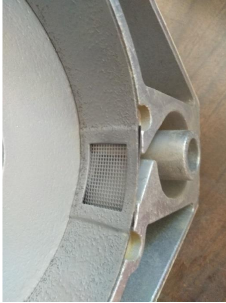
Figura 13. Detalle de criba del molino CYCLOTEC 1093 Sample. Fuente: Elaboración propia.
