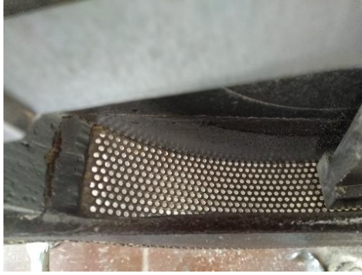
Figura 10. Detalle de la criba del molino C&N. Fuente: Elaboración propia.
