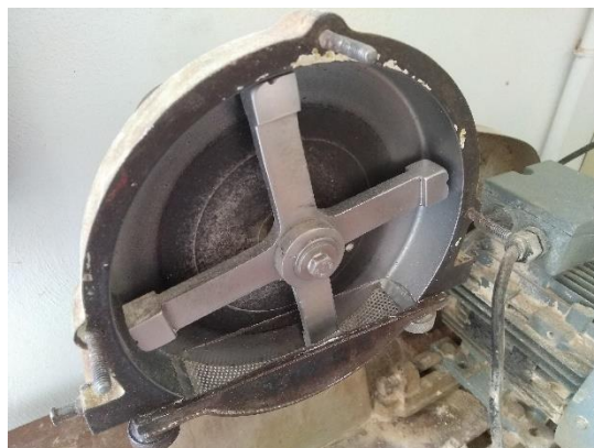
Figura 9. Detalle de los martillos del molino C&N. Fuente: Elaboración propia.
