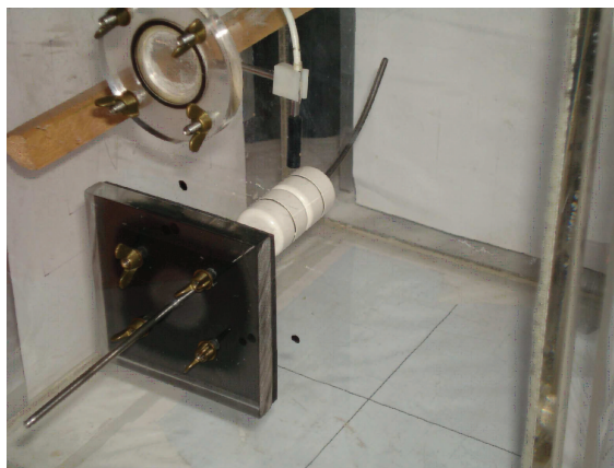
Fig. 4.1 Position de la chambre d'ionisation par rapport à l'applicateur dans le dispositif expérimental.
