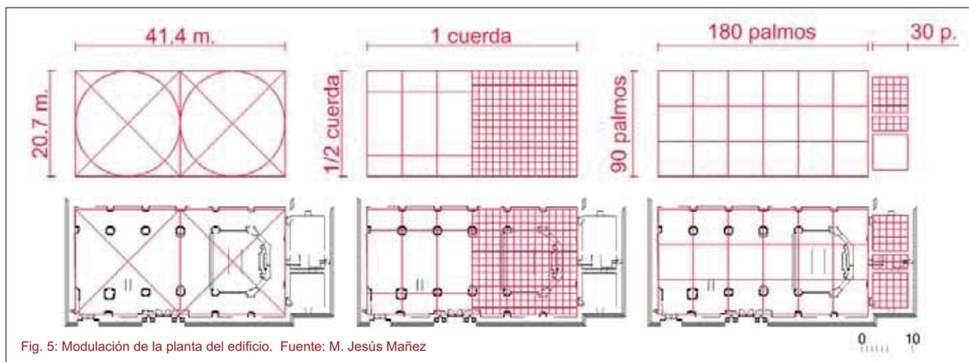
Fig. 5: Modulación de la planta del edificio. Fuente: M. Jesús Mañez
