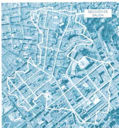
Figura 8. Foto aérea de la cuenca, sus límites y traza de conductos existentes.
