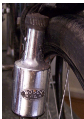
Dinamo antico, quando si collocava vicino alla ruota
