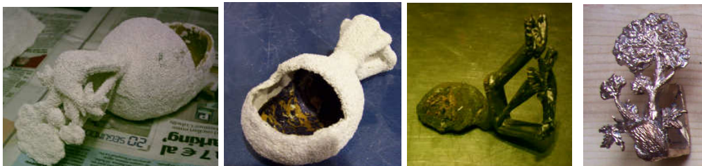
139. Exemple de realització del procés de fosa per gravetat.
