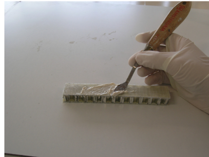
Aplicación de Beva-Gel en una de las probetas de ensayo
