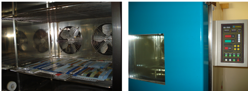
Imágenes de las probetas en la cámara de envejecimiento
