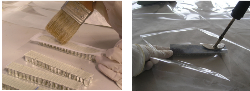
Preparación de las muestras mediante adhesivo termoplástico
