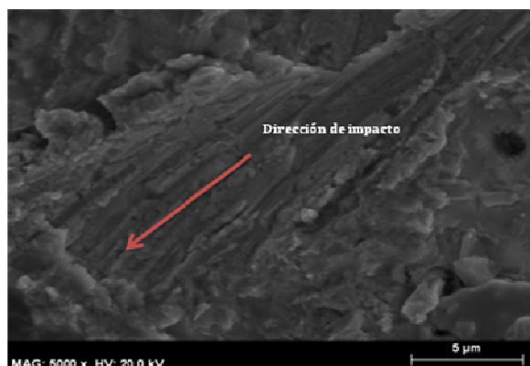
Figura 5.18. Imagen SEM, Mecanismo de erosión sobre un recubrimiento micrométrico proyectado con una intensidad de 625 A y erosionado con un ángulo de 45°
