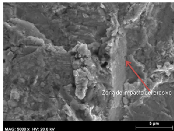
Fig. 5.22. Imagen SEM, mecanismo de erosión, recubrimiento micrométrico proyectado con una intensidad de 625 A, erosionado a un ángulo de 90°.
