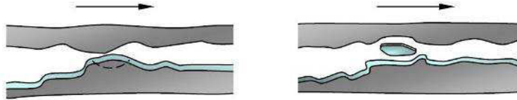
Figura 3.23 Desgaste por fatiga entre dos superficies en deslizamiento.
