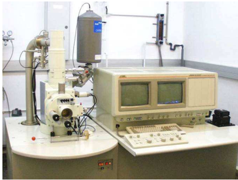
Figura 4.21 Microscopio electrónico de barrido JEOL JSM 6300, que incorpora un detector de elementos ligeros ISIS Link de la casa Oxford.
