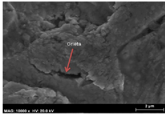
Fig. 5.19. Imagen SEM, Mecanismo de erosión en recubrimiento nanométrico proyectado con una intensidad de 625 A, erosionado a un ángulo de 90°.
