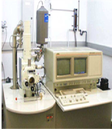
Figura 4.10 Microscopio electrónico de barrido JEOL JSM 6300, que incorpora un detector de elementos ligeros ISIS Link de la casa Oxford.
