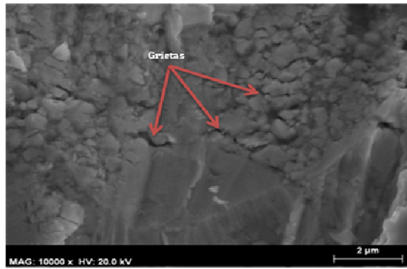
Fig. 5.21. Imagen SEM, mecanismo de erosión en recubrimiento micrométrico proyectado con una intensidad de 625 A, erosionado a 90°.
