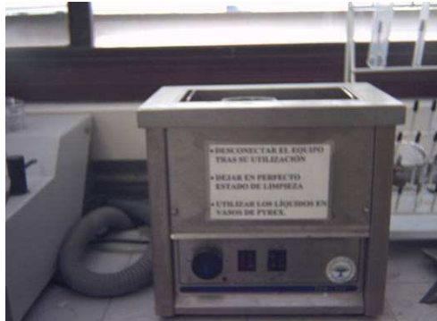
Figura 4.18 Equipo de limpieza por ultrasonidos Metason 120.
