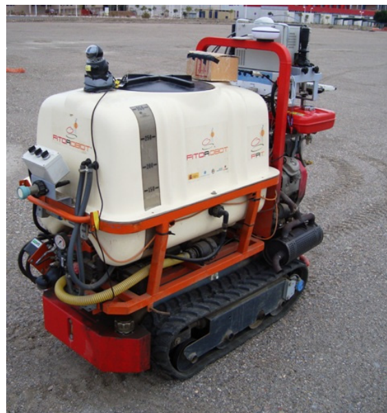
Figura 3: Robot móvil Fitorobot. Notar el sistema de locomoción basado en orugas de goma. También se pueden apreciar algunos sensores como: la antena del DGPS, codificador (eje trasero de la oruga), cámaras de visión, brújula magnética (debajo de la cámara frontal), sonares (parte frontal y lateral). El robot está controlado por un PC industrial colocado en la parte trasera del robot (junto al marco antivuelco y a los joysticks para el manejo manual).
