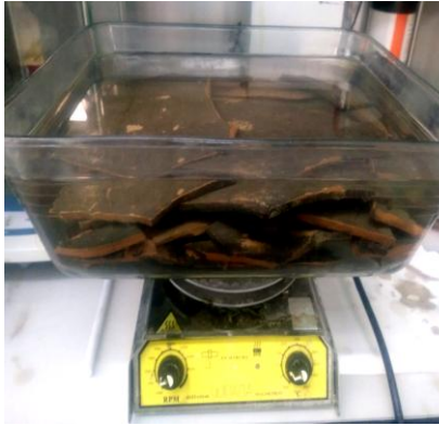
Fig.46. Baño de EDTA en una solución al 5% de una mezcla al 50% de EDTA bisódico y de EDTA tetrasódico en agua destilada, en agitador magnético. (Archivo SIP del Museu de Prehistòria de València 2019).
