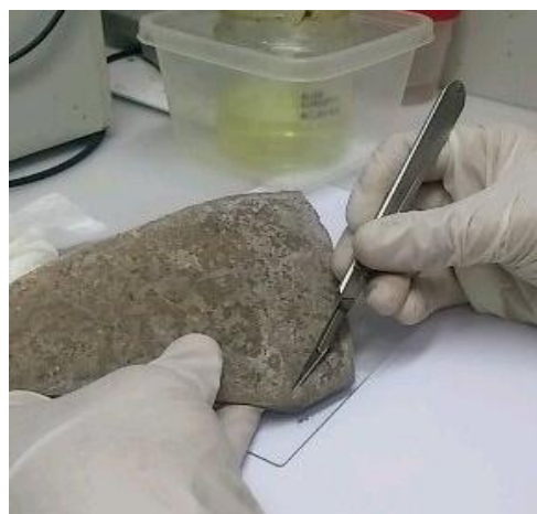
Fig.65. Extracción de costra adherida, para prueba de detección de carbonatos.
