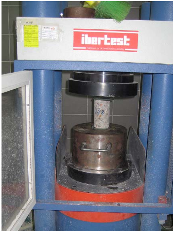
Figura 3. 4. La máquina de rotura por resistencia a compresión.
