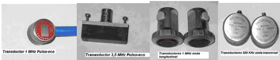
Figura 3. 8. Los transductores Utilizados en los ensayos por ultrasonido (Tx- Rx) y (Pulso-eco)
