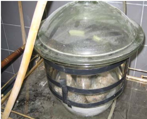
Figura 3. 6. Montaje experimental empleado para absorción de agua por inmersión a vacío.
