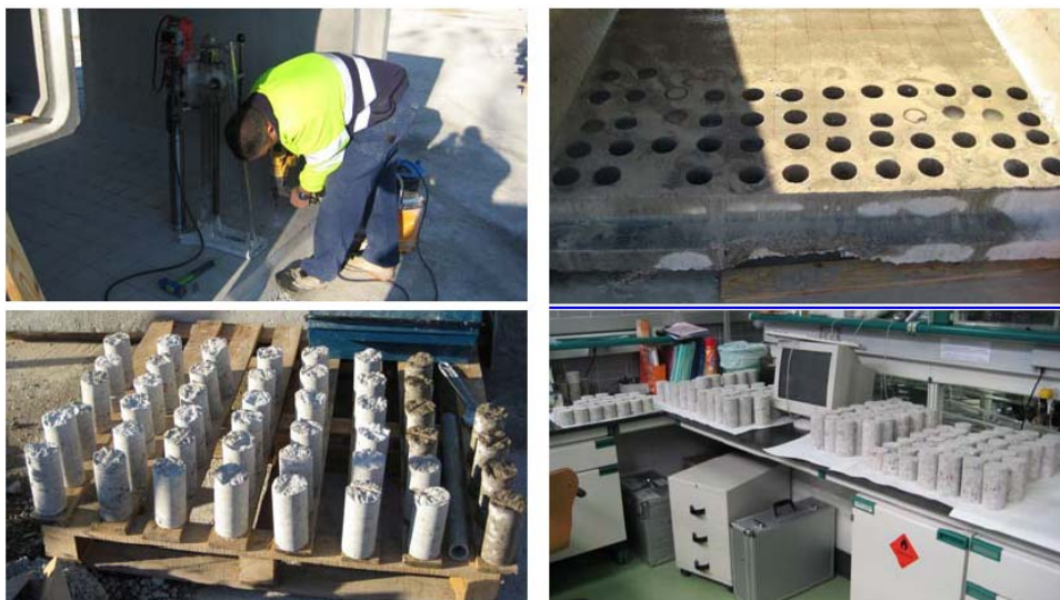
Figura 3. 3. Fotografías del Proceso de Extracción de los testigos y su disposición en el laboratorio para la realización de las inspecciones no destructivas
