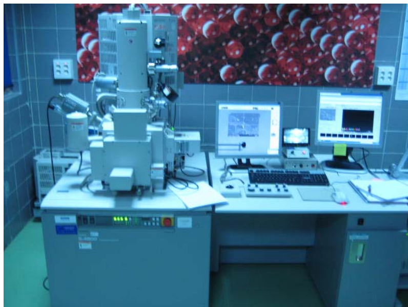
Figura 3. 14. El equipo de Microscopía Electrónica de Barrido.
