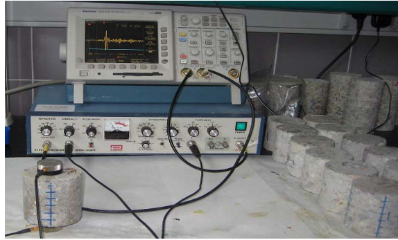
Figura 3. 7. Imagen del equipo de ultrasonido Panametrics 5058PR y Osciloscopio Tektronics TDS3012.
