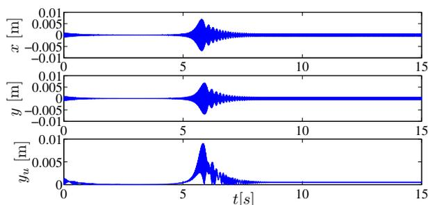
Figura 4: Respuesta al desbalance del sistema rotor-chumacera sin balanceo activo.
