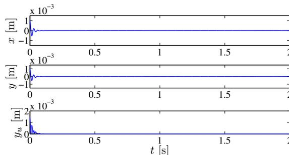
Figura 6: Respuesta del balanceo activo del sistema rotor-chumacera.
