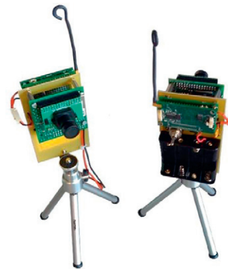
Figura 6: Nodo de la red inalámbrica compuesto por un nodo Xbow y un módulo CMUCAM3 .
