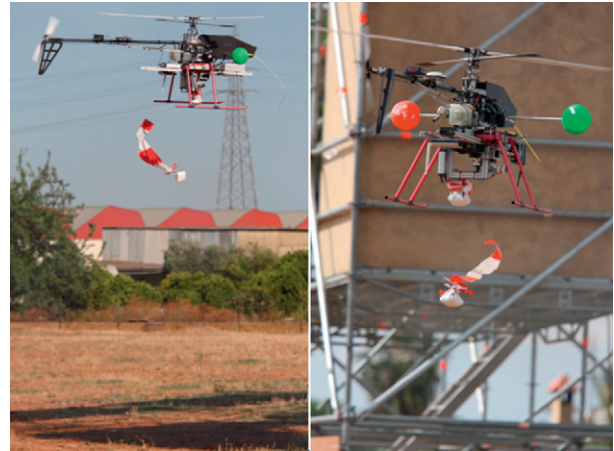
Figura 5: Despliegue de nodos de la red de sensores inalámbrica mediante un helicóptero autónomo.
