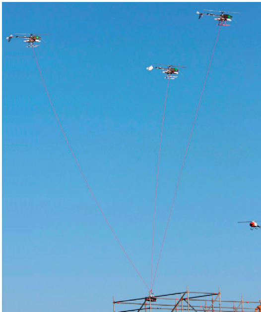
Figura 10: Transporte cooperativo de una carga mediante 3 UAVs.
