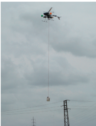
Figura 3: Transporte de carga mediante un helicóptero autónomo.
