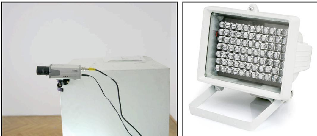
*fig 105 y 106. Scratch it - Cámara firewire y foco de leds infrarrojos.*
