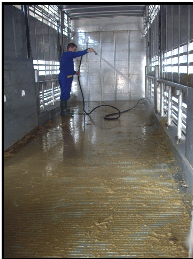
Fig. 21: Limpieza vehículo comenzando por la zona más profunda.
