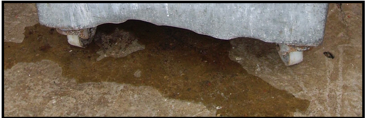
Fig. 28: Fuga de líquidos en contenedor de subproductos. Fuente: Propia
