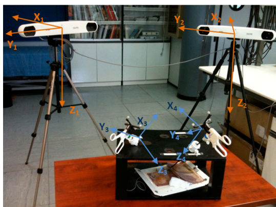
Figura 15. Sistemas de referencia en el montaje experimental.
