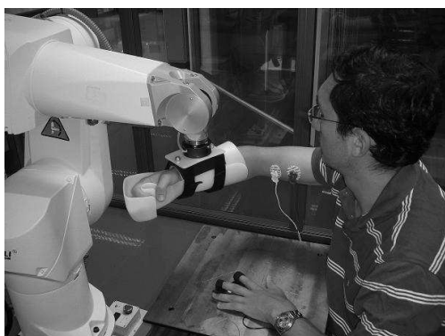
Figura 1. Robot de asistencia para tareas de rehabilitación de los miembros superiores, en el laboratorio del centro tecnológico Cartif.
