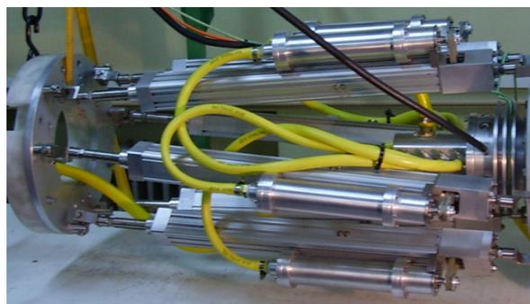
Figura 3. Plataforma paralela y sus actuadores lineales
