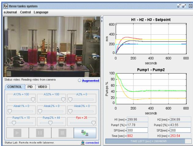
Figura 6. GUI del sistema de tres tanques – modo remoto con realimentación por video.
