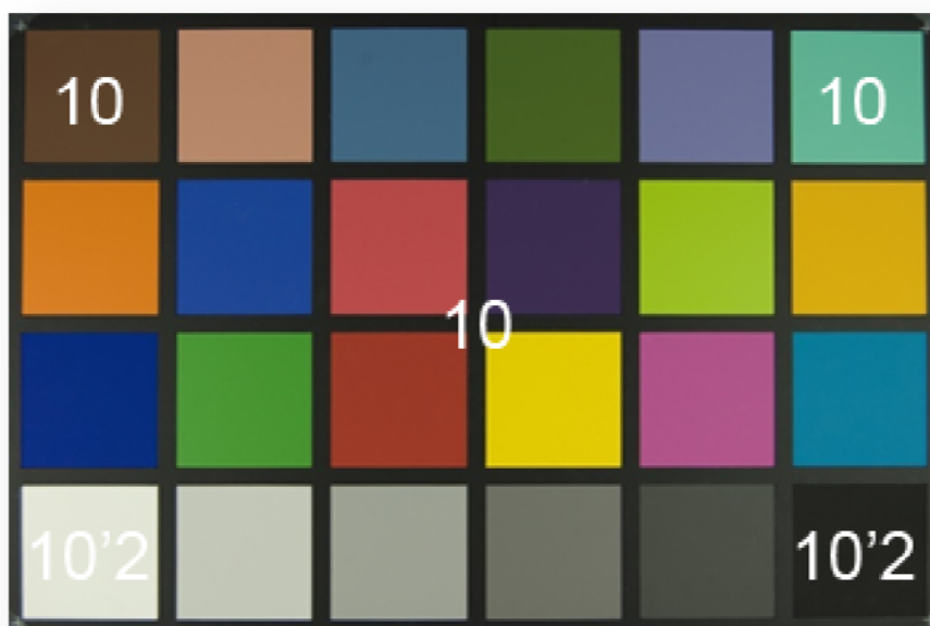
Figura 2. Mediciones con fotómetro para obtener una iluminación homogénea del patrón
