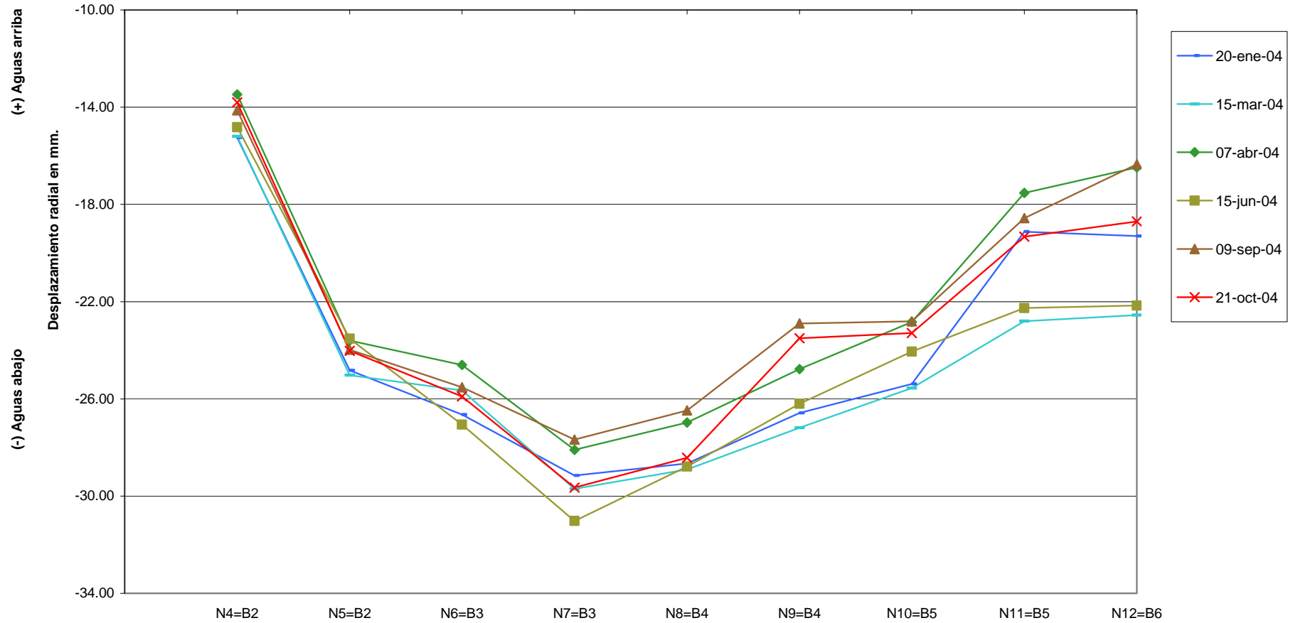
Gráfico G3. Evolución temporal de la colimación en la presa de Val, año 2004.
