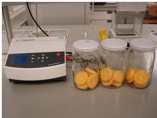
Figura 3: Analizador de gases de espacio de cabeza Dansensor® y sistema estático para análisis de tasas respiratorias en rodajas de caqui
